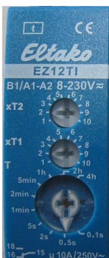
In der Front des Taktgebers K2 befinden sich die Schalter für die Zeitbasis T und den Multiplikator xT1 und xT2. Mit xT1 wird die Dauer der Rückspülung z.B. 1 s und mit xT2 die Pausenzeit zwischen den einzelnen Rückspülstößen z.B. 1 s eingestellt.
