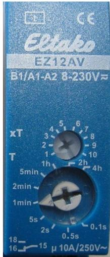
Das Zeitrelais K1 (EZ12AV) beendet nach dem Rückspülvorgang mit einer Zeitverzögerung von z.B. 1 min. die Meldung „Rückspülen“ und gibt die Messung wieder frei, damit sich beim Umschalten von Spülen auf Messen aktuelles Messgas in den Analysatoren befindet.
