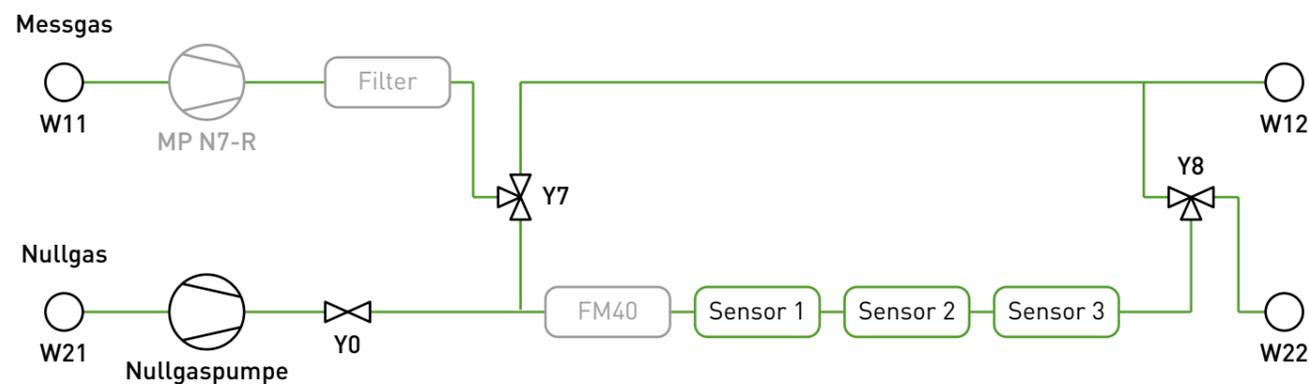
Beispielanordnung mit Nullgaspumpe und separatem Ausgang für Kalibriergas.
