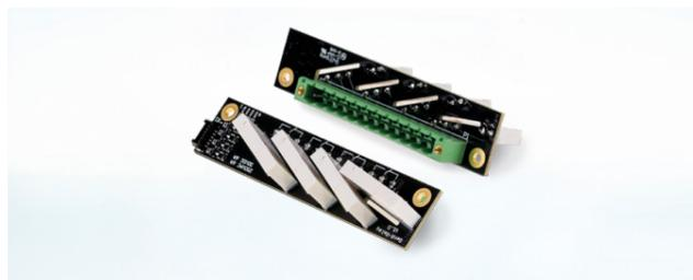
Alternativ zu unserem AutoZero-Modul kann auch eine Schnittstellenkarte mit drei potenzialfreien Wechselkontakten integriert werden, die den Betrieb einer externen Kalibriervorrichtung ermöglicht. Mithilfe dieser Schnittstellenkarte können unabhängig voneinander ein Nullgasventil und ein Kalibriergas-Ventil angesteuert werden.
