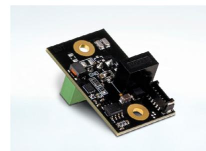
Pro Messkanal kann jeweils durch eine Zusatzkarte ein galvanisch getrennter Analogausgang mit 0-20/4-20 mA realisiert werden. Zusätzlich kann ebenfalls pro Messkanal eine Relaiskarte mit vier Digitalausgängen verbaut werden. Zwei der Digitalausgänge geben eine Rückmeldung über den eingestellten Messbereich, mithilfe der beiden anderen Ausgänge werden Grenzwertüberschreitungen übermittelt. Zur Anbindung externer Sensoren kann der Analysator zudem mit einer CAN-Schnittstelle bestückt werden.
