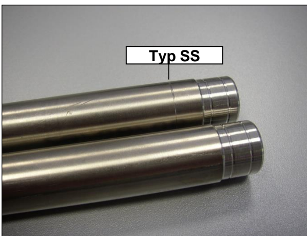
Abbildung 3 Einkerbung als Unterscheidungsmerkmal für beide Kartuschentypen
