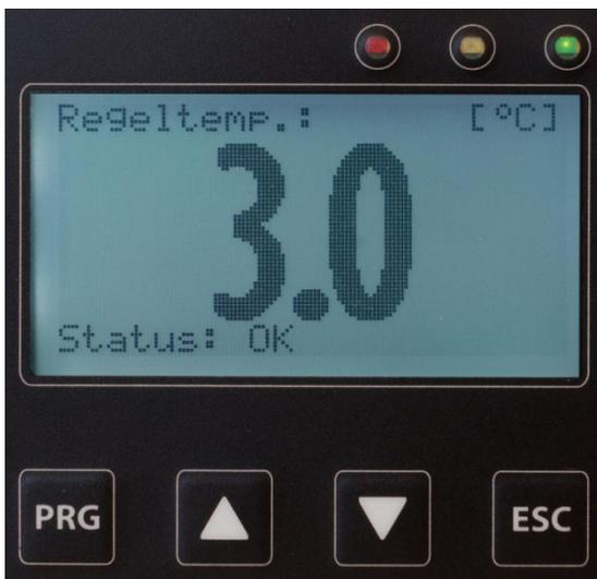
Abbildung 11 Frontansicht der TCU im Normalbetrieb
