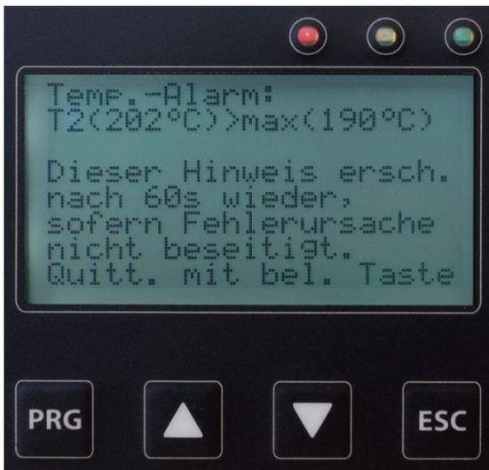
Hierdurch wird verhindert, dass die beheizte Leitung durch einen Defekt überheizt! Der ausgelöste Alarm (rote LED) muss mit einer beliebigen Taste quittiert werden. Wird der Fehler nicht behoben, so kommt der Fehlerbildschirm nach 60 s wieder.
