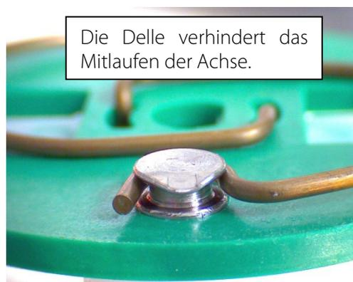
**Abbildung 10 Überprüfung der Achsen der Andruckrollen**
