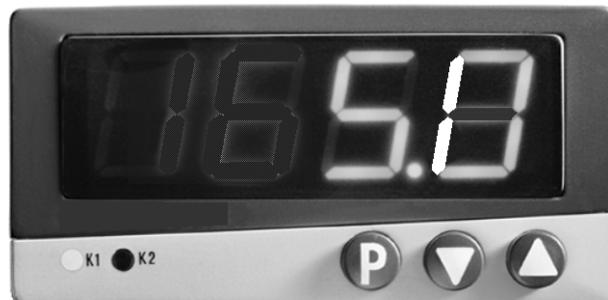
Abbildung 12 Frontansicht des Temperaturreglers bis 03.2022
