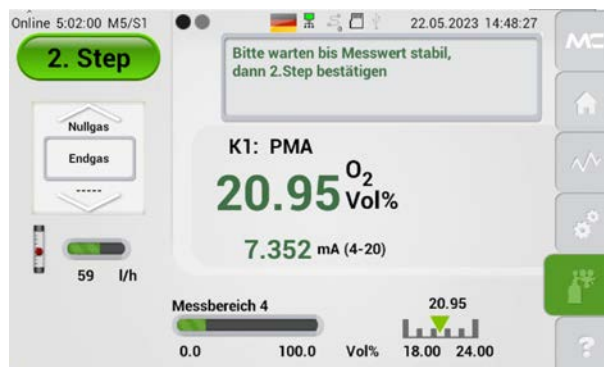
Abb. 74: Zweiter Schritt der manuellen Kalibrierung
