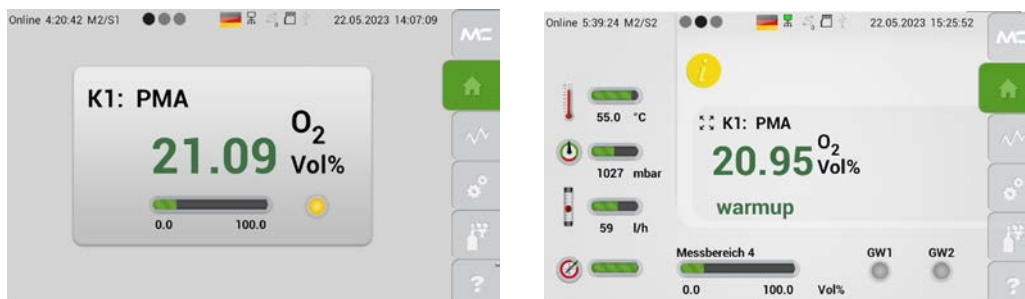
Abb. 68: Bildschirm M2/S1 mit Anzeige (gelbe LED) und M2/S2 in der Aufwärmphase
