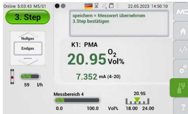
Abb. 75: Dritter Schritt der manuellen Kalibrierung
