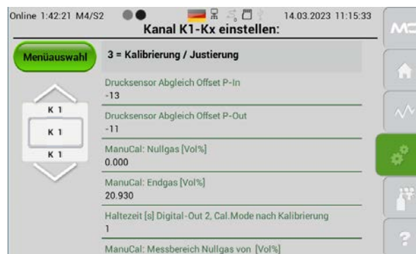
Abb. 71: Einstellungen der kanalspezifischen Kalibrierparameter
