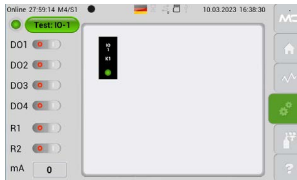
Abb. 62: IO1-Komponenten: DO1 bis 4, Relais-Ausgänge R1, R2 und mA-Ausgang
