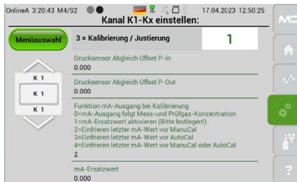
Abb. 89: mA-Einstellung: Seite M4/S2, 3=Kalibrierung/Justierung
