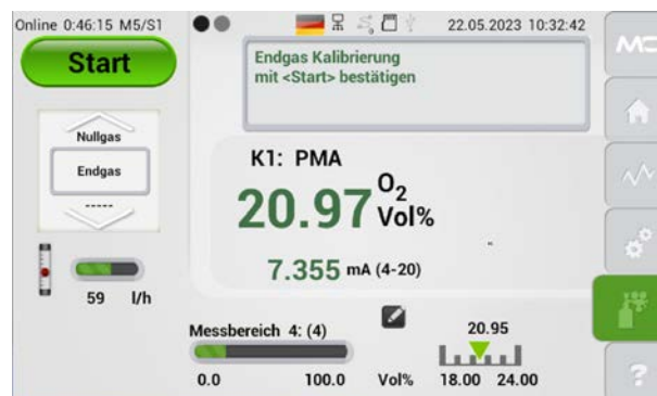
Abb. 65: Bildschirm zur Gaskalibrierung
