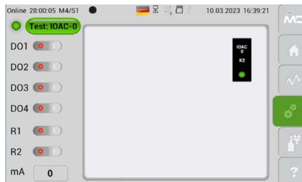
Abb. 84: Diagnosen-Diagramm: Geöffnete Ausgangskarte zu Kanal K2
