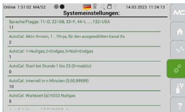
Abb. 90: Parameterneinstellungen bei AutoCal
