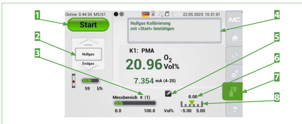
Abb. 70: Manuelle Kalibrierung (ManuCal)
