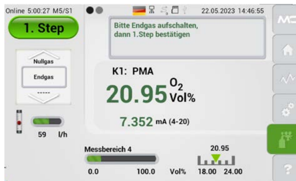
Abb. 73: Erster Schritt der manuellen Kalibrierung
