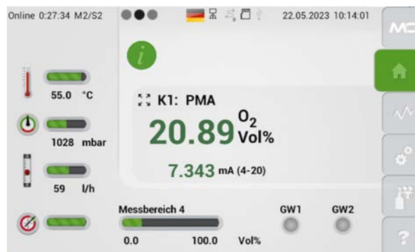
Abb. 30: M2/S2 - Detaillierte Informationen zu den Messparametern
