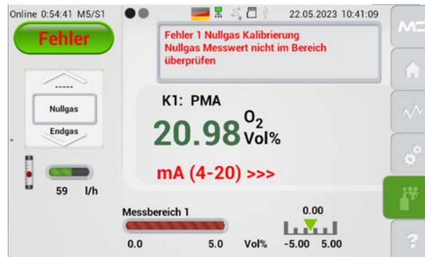
Abb. 79: Fehler bei der manuellen Kalibrierung
