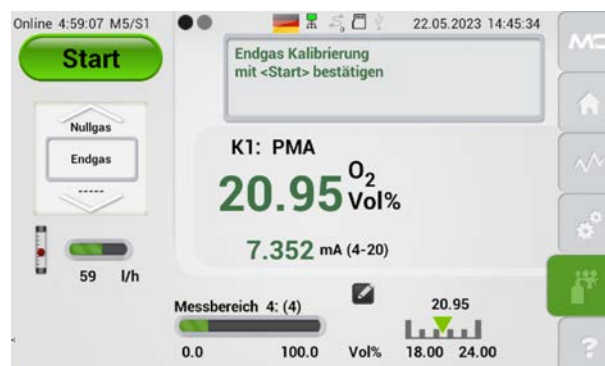
Abb. 72: Manuelle Kalibrierung mit Endgas
