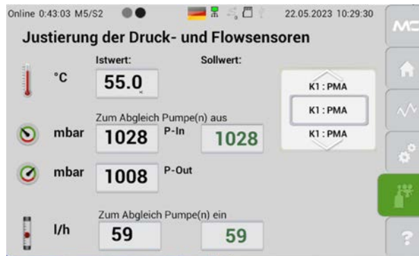
Abb. 66: Justierung der Druck- und Flowsensoren
