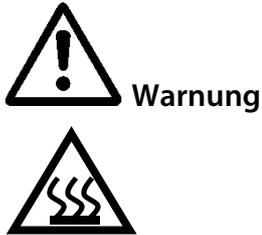
Achtung, die beheizte Einrichtung muss fest montiert werden. Bei der Montage sollte ein Mindestseitenabstand von 100 mm zu anderen Bauteilen eingehalten werden, damit kein störender Wärmestau entsteht.
