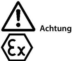
Elektrostatistische Entladungen können in explosionsgefährdeten Bereichen als Zündfunken wirken. Vermeiden Sie elektrostatische Aufladung der Gehäuseoberfläche durch Reibung. Reinigen Sie das Gerät nicht mit einem trockenen Tuch.
