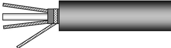
7. Die dünnen, Schrumpfschläuche (f) über die Versorgungsleiter schieben und schrumpfen
