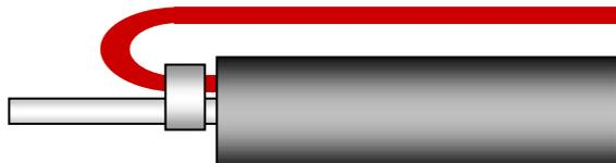
7. Silikonkleber auf das Ende des Heizschlauches und der Endkappe (a) auftragen. Kappe (a) auf Schlauch aufschieben und Kleber trocknen lassen.
