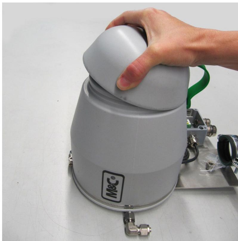
**Abbildung 4** Öffnen der Isolierkappe
