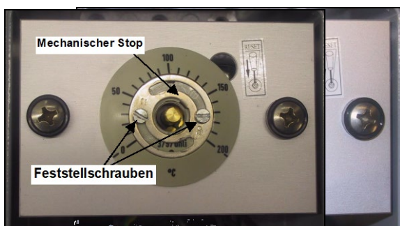
Abbildung 18 Mechanischer Stop des Thermostaten
