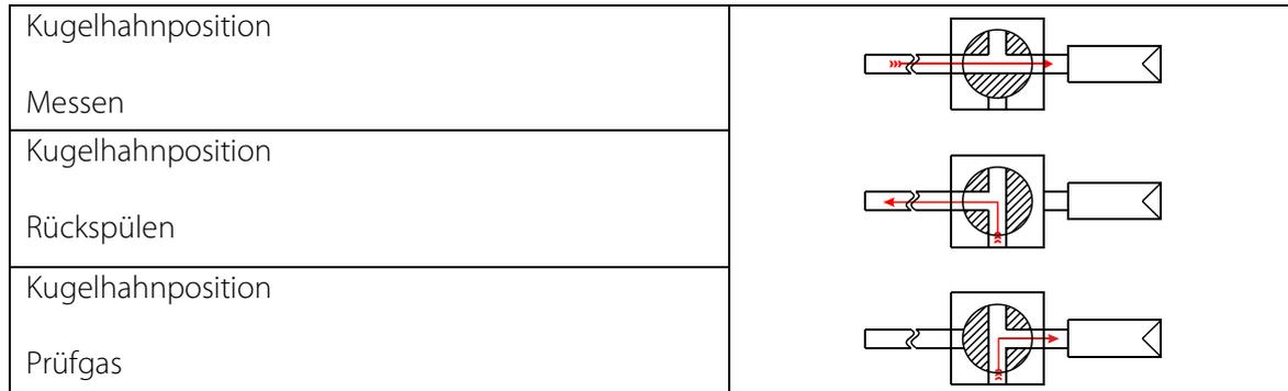
**Abbildung 3 Funktionsschema der Option 3/2-Wege-Kugelhahn /3VA**
