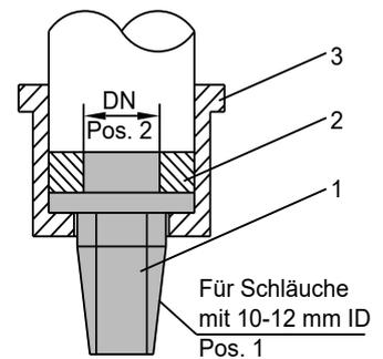
Pos. 1: Gerader GL-Schlauchnippel-Anschlussadapter
