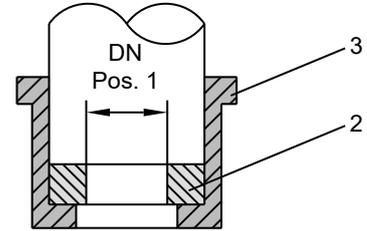
Pos. 1: Innerer Durchmesser des GL-Klemmrings
