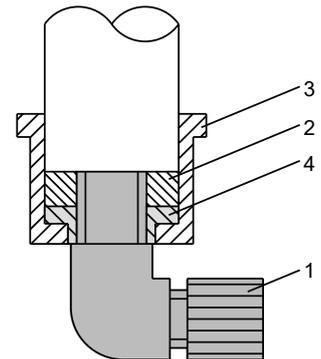
Pos. 1: GL-Winkel-Schlauchanschlussadapter
