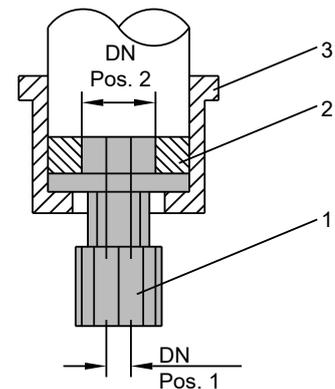
Pos. 1: Gerader GL-Schlauchanschlussadapter
