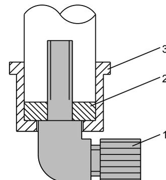
Pos. 1: Einstellbarer GL-Winkel-Schlauchanschlussadapter
